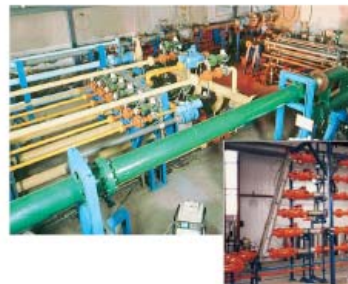
Bancs de débitmétrie haute-pression utilisant des tuyères soniques comme référence
